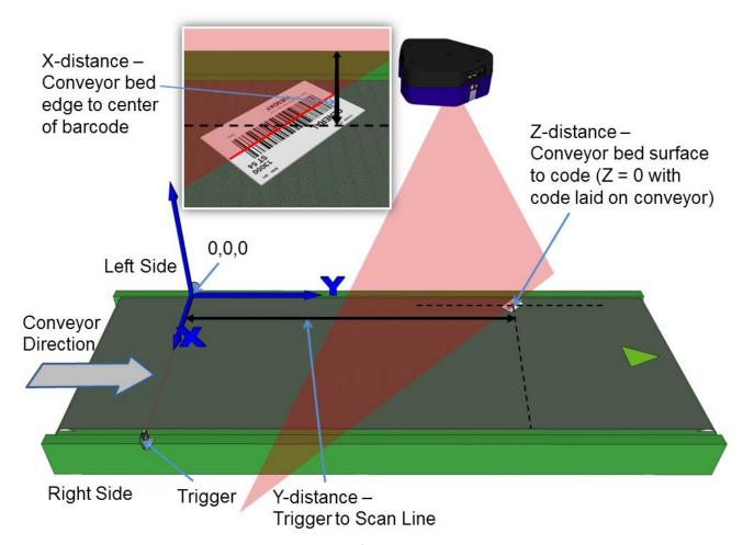
Figure 43: Top-read 1<sup>st</sup> barcode placement
