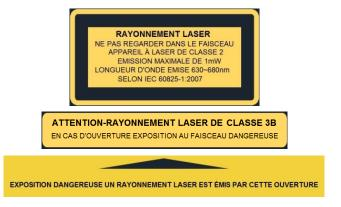
Figure 2: Exemple d'étiquettes d'avertissement laser
